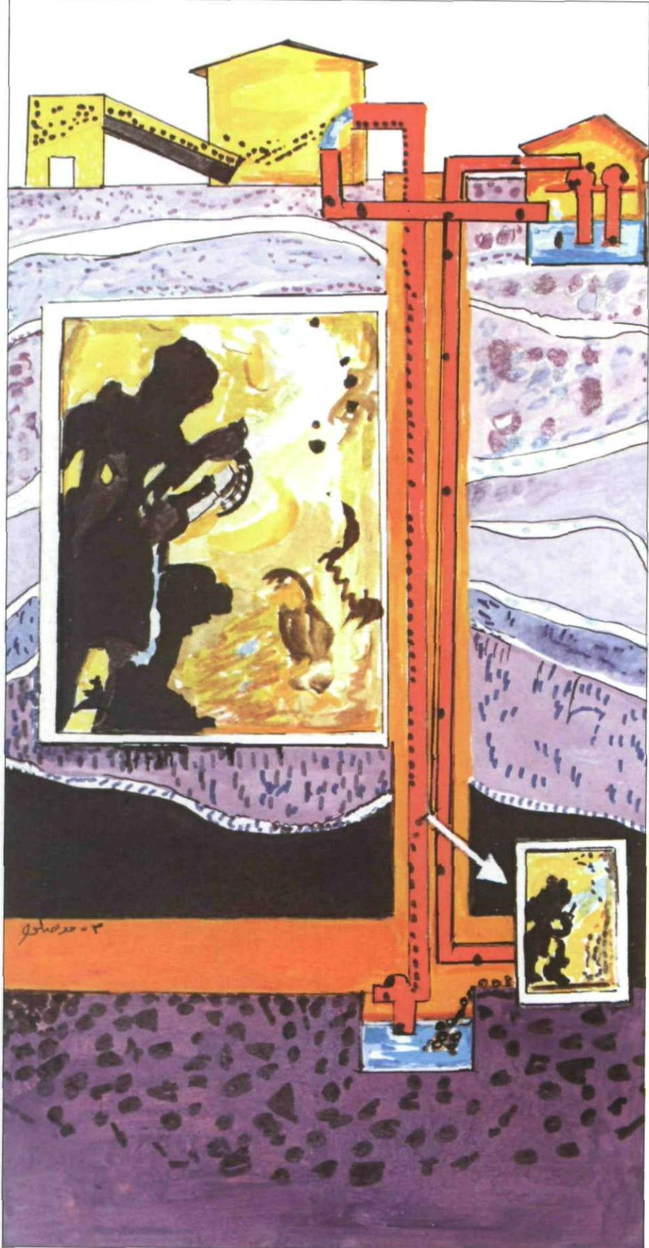
قطع نجم فحم حيث يجري قطع الفحم بطريقة استخدام المياه التي تحمل قطع الفحم معها إلى السطح.
