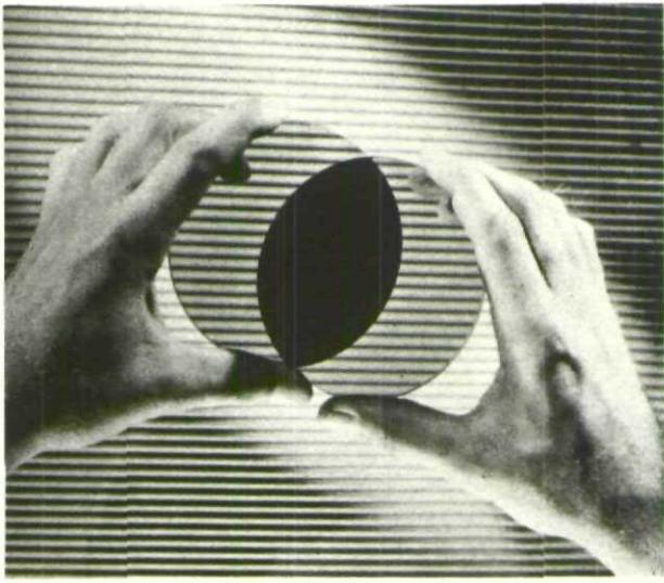
يمثل هذا المشهد مربى المقياس الطيفي التابع لختبر لنكولن ويبلغ قطره ٤٨ بوصة . وهو جهاز دقيق وحساس يستخدم في قياس طيف الأشعة دون الضرر وفوق البنفسجية . ومن ميزاته أنه يسمح في حل المشاكل المتعلقة بالمركبات الفضائية وتعقب آثارها .
